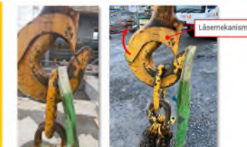
Venstre bilde illustrerer hvordan fiberstroppen ble hengt på og høyre bilde illustrerer hvordan fiberstroppen hang utenfor kroken låsemekanisme før den falt av.
